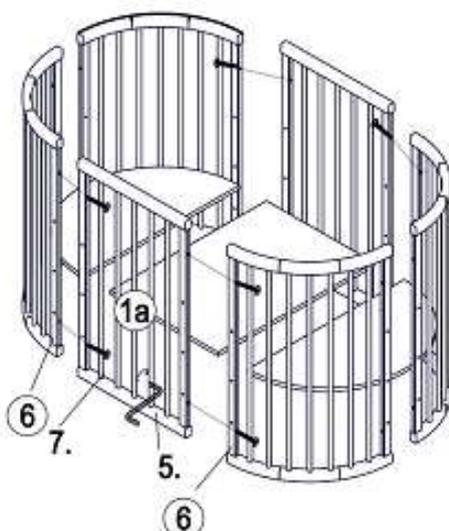
5. Установить секции боковые и среднюю на место и закрепить между собой винтом мебельным М6х60 (поз.6), как показано на рисунке.
