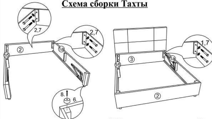
1. Перед сборкой каркаса установить ножки (поз.6) на место и закрепить саморезами 5х35 (поз.8).
