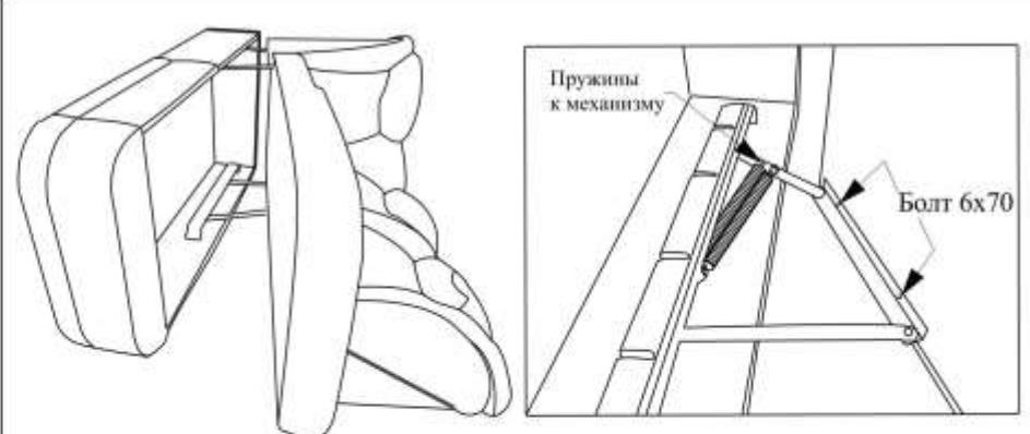
2. Положить ящик подъемной части и сиденье диванной части боковиной на ровную поверхность
